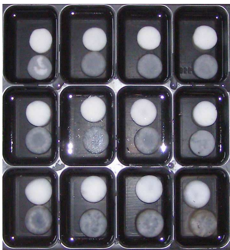
Obr.27 Vyrobené fantómy pre mechanické skúšky. Tmavšie valce sú fantómy s pridaným grafitom, svetlejšie bez grafitu.
