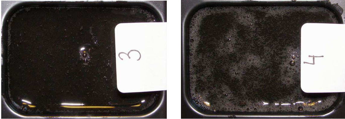
Obr.19 Príprava grafitových fantómov na zmrazenie. Vo fantóme A je pridaných 0.6 g, v B je 1.2 g, v C je 1.8 g a v D je 2.4 g grafitu na 130 ml kryogelu
