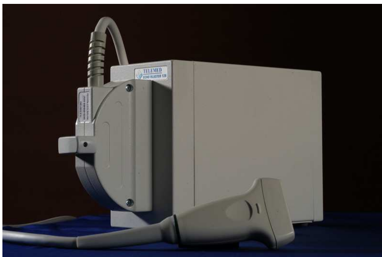
Obr.6 Generátor pulzov s pripojenou lineárnou sondou
