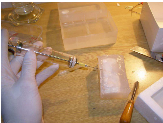
Obr.43 Vyťahovanie bubliniek injekčnou striekačkou z fantómu, na ktorom sme overovali vplyv nedostatočného roztopenia
