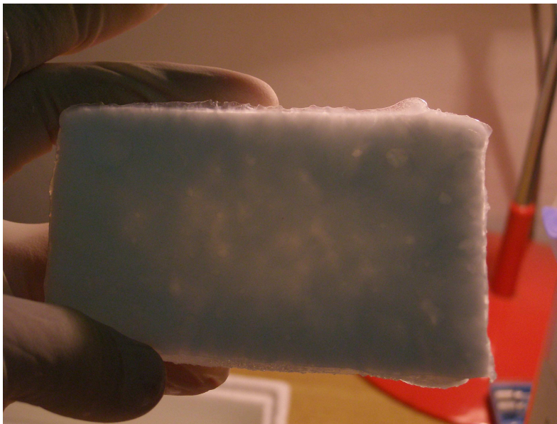
Obr. 45 Viditeľné rozdiely v hustote materiálu a priehľadnosti fantómu proti svetlu – vnútoraná časť bola na dotyk po rozmrazení citelne mäkšia pretože prešla menším počtom ZaR cyklov.
